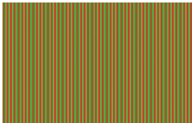
Abb. 9: Interlacing nach ungünstiger Verarbeitung in der Vorstufe
